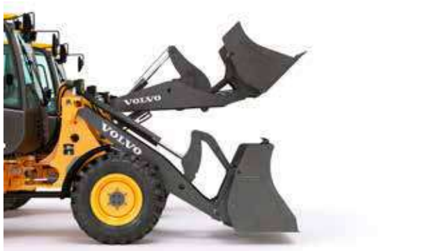
Scelta tra leverismo parallelo o a Z (L25 Electric)
